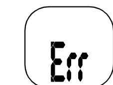
Si no coloca el compás correctamente al calibrarlo, aparece el mensaje abreviado Err [error]. Si sucede tal cosa comience de nuevo.
